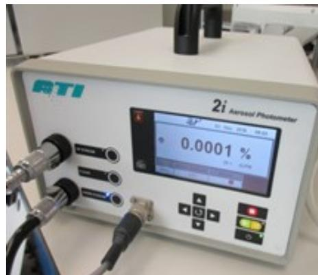
**Fotometro per la misurazione della penetrazione locale a scansione su filtri HEPA e ULPA**
