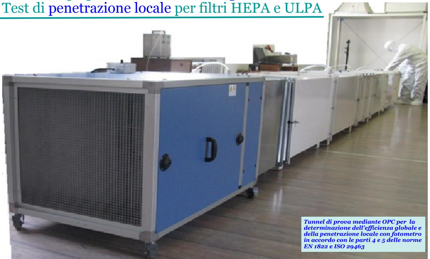
**Tunnel di prova mediante OPC per la determinazione dell'efficienza globale e della penetrazione locale con fotometro in accordo con le parti 4 e 5 delle norme EN 1822 e ISO 29463**
